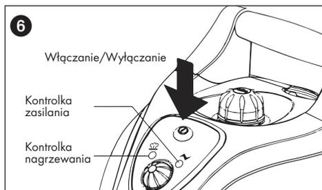
Zapala się pomarańczowa kontrolka zasilania (ilustracja 6) i odkurzacz parowy zaczyna się nagrzewać. Odpowiednia do pracy temperatura zostaje osiągnięta po ok. 11 minutach. Wówczas zapala się zielona kontrolka nagrzewania. Urządzenie jest teraz gotowe do pracy.
