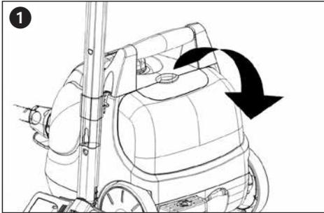
Entnehmen Sie das erforderliche Zubehörteil, und schließen Sie die Abdeckung. Schieben Sie den Riegel der Abdeckung in die Aussparung, und drücken Sie ihn fest nach unten, bis er einrastet.
