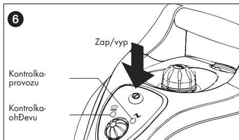
Rozsvítí se oranžová kontrolka provozu (obrázek 6) a parní čistič začne ohřívat vodu. Provozní teploty je dosaženo přibližně za 11 minut, což je signalizováno rozsvícením zelené kontrolky ohřevu. Přístroj je nyní připraven k provozu.
