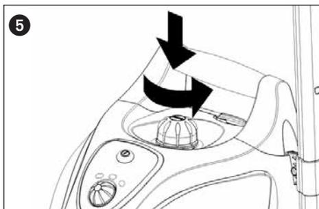
Utiliser uniquement de l'eau pure sans additif, comme du parfum, du détergent ou de l'alcool, afin de ne pas endommager l'appareil ou de rendre son utilisation dangereuse. Il est recommandé d'utiliser de l'eau distillée afin d'éviter tout dépôt calcaire lorsque l'eau est particulièrement dure (valeurs supérieures à 2,5 mmol/l ou 21 °dH). Dans le cas contraire, faire bouillir l'eau avant d'utiliser l'appareil afin d'allonger sa durée de vie.
