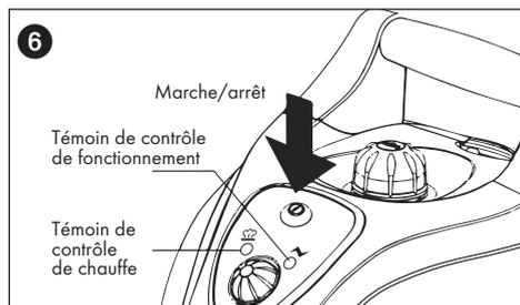
Le témoin de fonctionnement orange (figure 6) s'allume et le nettoyeur vapeur commence à chauffer. La température de fonctionnement est atteinte au bout de 11 minutes environ ; le témoin de chauffe vert s'allume alors. L'appareil est opérationnel.
