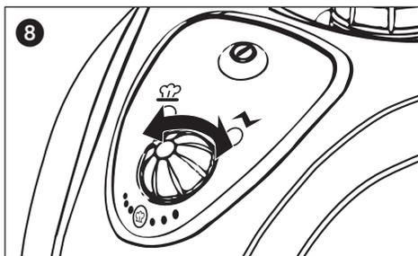
No incline el aparato más de 45° cuando esté en funcionamiento para garantizar que éste descansa siempre sobre un suelo firme. Con el depósito lleno, el aparato podrá usarse como máximo durante 50 minutos. No deje el aparato sin vigilancia cuando esté encendido y dado el caso, utilice el seguro a prueba de niños para bloquear la tecla de vapor. Para ello deslice hacia la derecha la pestaña triangular situada en el lado izquierdo de la pistola de vapor.
