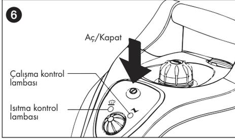
Turuncu renkli çalışma lambası (Şekil 6) yanar ve buharlı temizleyici ısınmaya başlar. Yaklaşık 11 dakika sonra çalışma sıcaklığına erişilir ve yeşil ısınma kontrolü lambası yanar. Cihaz artık çalışmaya hazırdır.
