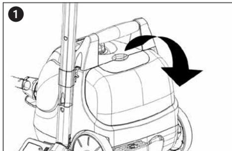
Выньте требуемую принадлежность и закройте крышку. Сместите фиксатор крышки в вырез и крепко прижмите его вниз так, чтобы он зафиксировался.
