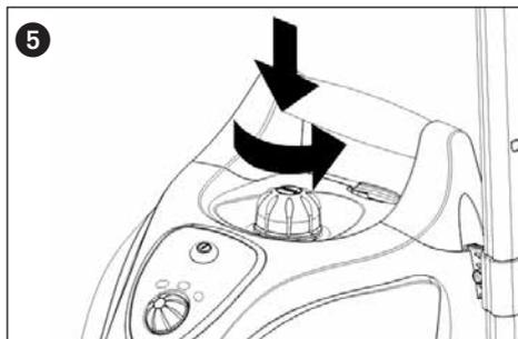
Do nádrže nalijete pouze čistou vodu bez jakýchkoliv přísad jako jsou např. parfémy, čisticí prostředky nebo alkohol, které mohou přístroj poškodit nebo při použití vyvolat nebezpečí. Doporučujeme použít destilovanou vodu. Příliš tvrdá voda (s hodnotami tvrdosti více než 2,5 mmol/l nebo 21 °dH) způsobuje usazování vodního kamene. Případně použijte převařenou vodu, abyste prodloužili životnost přístroje.
