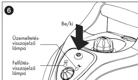
Az üzemelést jelző narancsszínű lámpa (6. ábra) kigyulad és a gőztisztító megkezdí a felmelegítést. A készülék az üzemi hőmérsékletet közelítőleg 11 perc múlva éri el; ekkor kigyulad a zöld felfűtés-visszajelző lámpa. Mostantól a készülék üzemkés.
