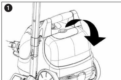
Proszę wybrać dany element wyposażenia i zamknąć pokrywę. Proszę wsunąć blokadę pokrywę we wgłębienie i docisnąć do momentu jej zatrzaśnięcia.
