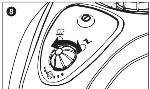
Під час роботи не нахилийте пристрій більше ніж на 45°, а також слідкуйте, щоб він завжди розташовувався на стійкій опорі. Повного бака вистачає щонайбільше на 50 хвилин роботи. Не залишайте ввімкнений пристрій без нагляду і за необхідності використовуйте захист від використання дітьми, щоб заблокувати кнопку подачі пари. Для цього пересуньте трикутний штифт на лівому боці парового пістолета праворуч.
