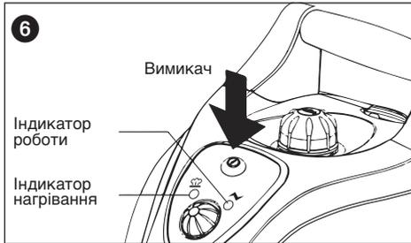
Засвітиться жовтогогарячий індикатор роботи (мал. 6), і пароочищувач почне нагрівання. Робочої температури буде досягнуто приблизно за 11 хвилин, після чого засвітиться зелений індикатор нагрівання. Після цього пристрій буде готовий до роботи.
