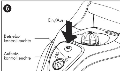
Die orangefarbene Betriebsleuchte (Abbildung 6) leuchtet auf und der Dampfreiniger beginnt aufzuheizen. Die Betriebstemperatur wird nach etwa 11 Minuten erreicht; daraufhin erleuchtet die grüne Aufheizkontrollleuchte. Das Gerät ist nun betriebsbereit.
