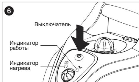
Оранжевый рабочий индикатор (рис. 6) загорается, и пароочиститель начинает нагрев. Рабочая температура достигается приблизительно через 11 минут; после этого загорается зеленый индикатор нагрева. Теперь прибор готов к работе.
