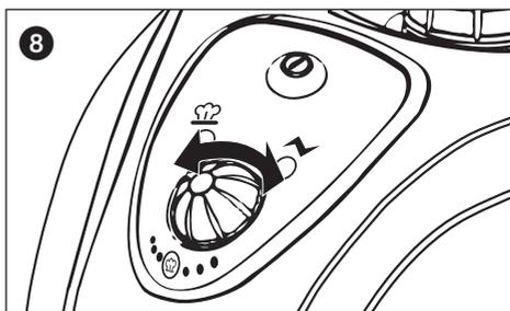
W trakcie pracy urządzenia nie wolno go przewracać ani przechylać pod kątem większym niż 45°. Należy się upewnić, że urządzenie stoi na twardym podłożu. Pełny zbiornik wystarcza na maks. 50 minut pracy. Nie wolno pozostawiać włączonego urządzenia bez nadzoru. Ewentualnie proszę używać zabezpieczenia przed dziećmi, aby zabezpieczyć przycisk pary. W tym celu należy przesunąć w prawo trójkątny trzpień znajdujący się po lewej stronie pistoletu parowego.
